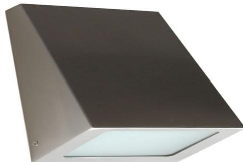
Dimensiones: 118 x 100 x 249 mm Luminaria de diseño moderno fabricada en acero inoxidable con un grado de protección IP44. Ofrece una protección eléctrica de clase I. Incorpora un portalámparas de tipo E27. Puede instalarse para iluminar hacia arriba o hacia abajo, para conseguir el efecto de iluminación deseado.
